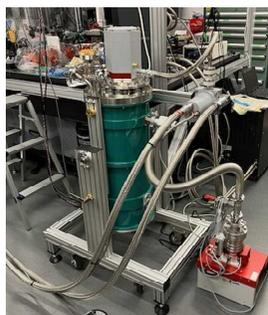
写真1: 導入した<sup>3</sup>He 冷凍機
