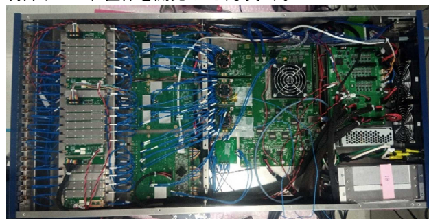
写真1：100量子ビット程度の制御を想定した制御装置
