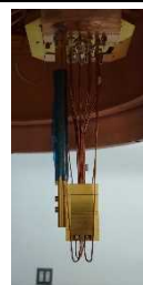
冷凍機に取り付けたモジュール用パッケージ
