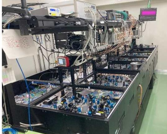
写真：フリースペース系で組んだ光量子コンピュータ実機
