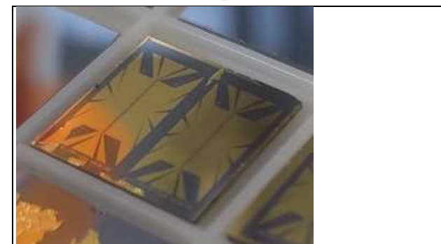
図4 半導体DBR上に形成されたトラップ電極
