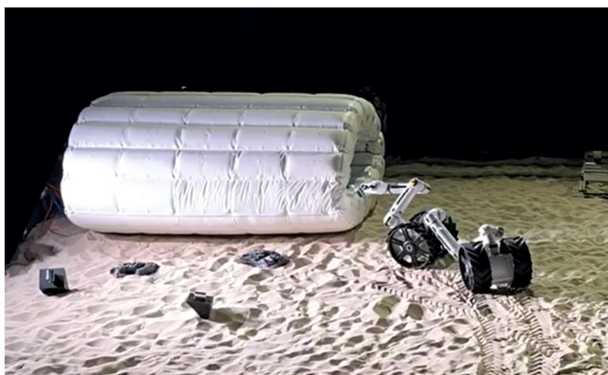
図 17 JAXA 宇宙探査実験棟・宇宙探査実験フィールドでの HIDAS 展開実験
