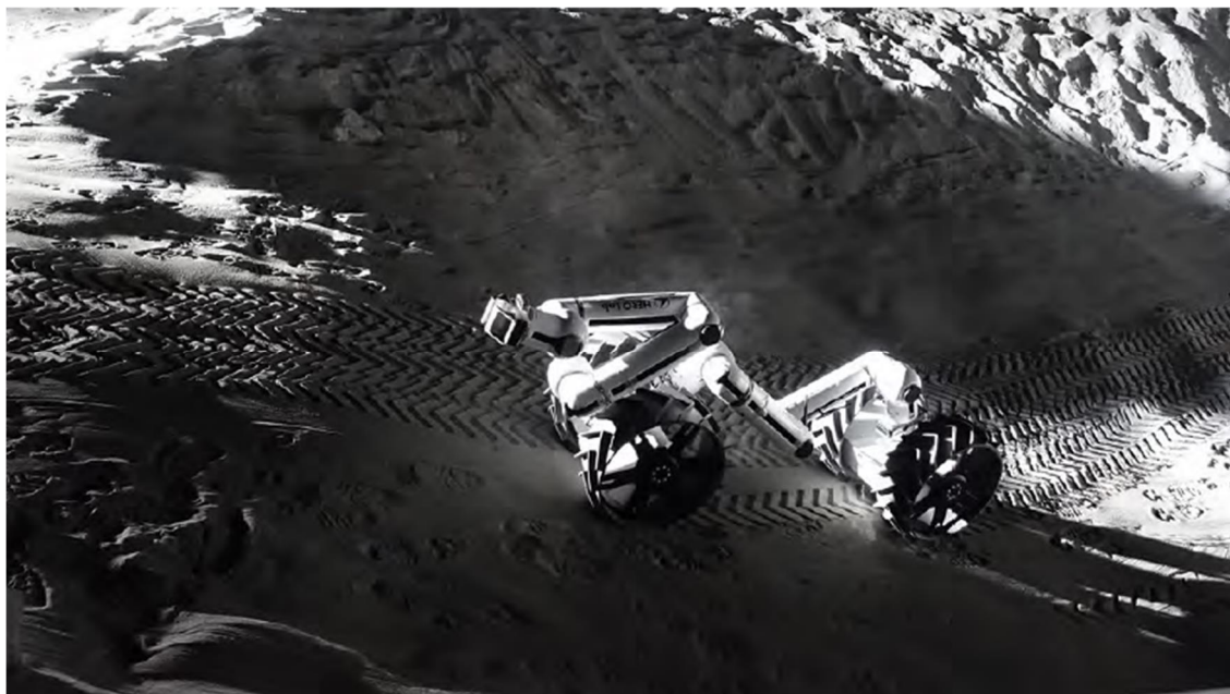
図 4-10 ESA/DLR Luna Analog Facility での実験で MoonBot が斜面登攀する様子 (傾斜 20°)
