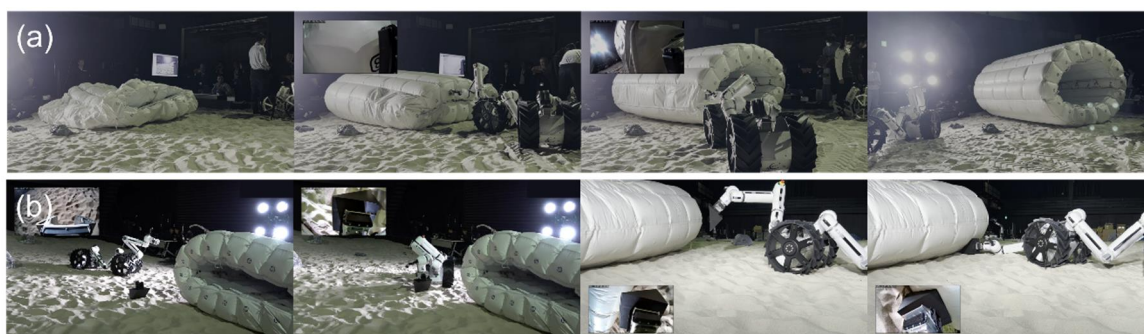
図 4-8 MoonBot によるインフレータブルモジュール HIDAS の展開支援作業の様子 (上段：膨張状態のモニタリング、下段：輪留めの設置)
