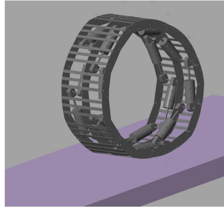
(a) 重心ヤコビアン構築のための模擬モデル
