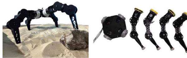
多肢型モジュラーロボットの検証モデル MoonBot 0
