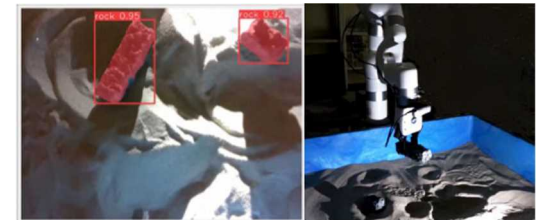
月面を模した光学環境下における岩石サンプルの認識・ピックアップ・積上
