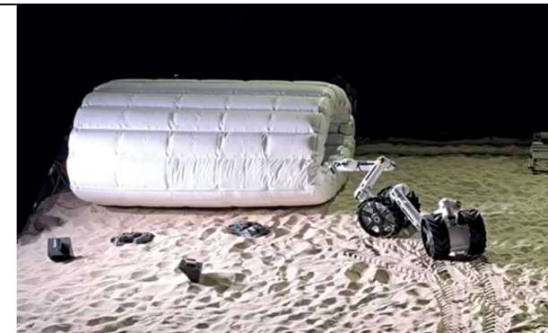
MoonBot による HIDAS (インフレータブル構造物) の展開支援
