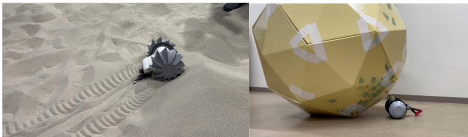
月面むけ設計を取り込んだ試験モデルによる緩詰珪砂上での跳躍試験
