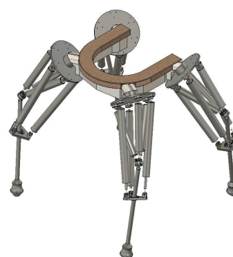
図 5 下肢 Nimbus Limb プロトタイプ案を用いたロボット歩行器
