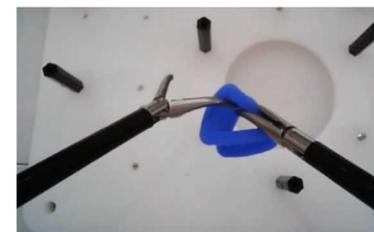
図 2-3 両手での物体の受け渡し操作の自律化
