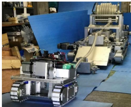
図2 排水ポンプ敷設ロボット i-CentiPot-Hose 試作機
