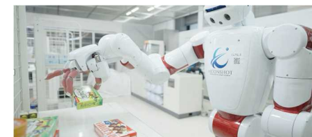
図3 Dry-AIRECによるコンビニ環境下での物体把持検証
