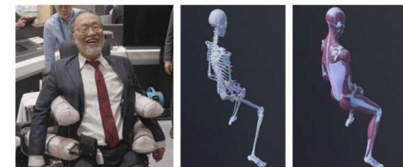
図 1: 福田 PD の腰痛緩和ロボットシステム 筋活動や骨格の動きを可視化しながら、優しい入力を加えることで、慢性腰痛の改善を試みました。
