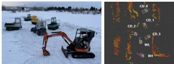
図 8 複数のセンサポッドによる複数建設機械の位置推定
