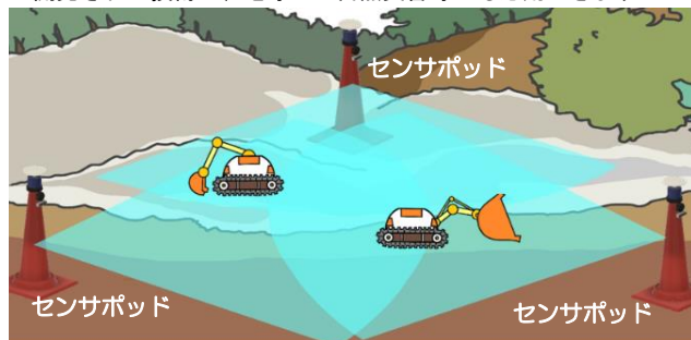
図 7 センサポッドによる環境情報ならびに建設ロボットの作業情報の取得イメージ
