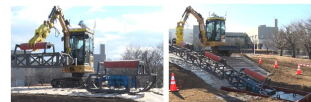
図 8 押し出しツールを用いた水中ポンプ投入の動作試験
