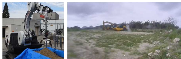
図 7 杭型センサポッドの設置（左）と得られた環境情報（右）
