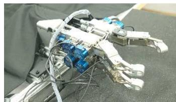
図3 回転式油圧アクチュエータハンドの一次試作機
