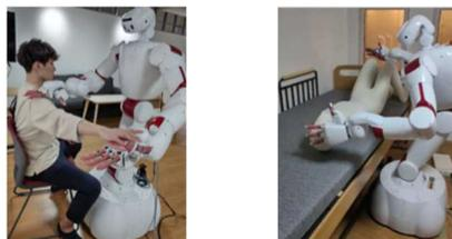
図2 関節可動範囲拡張動作と体位変換動作
