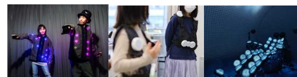
(2-1) 触覚を通じた身体感覚の共有装置(ジャケット型、椅子型)
