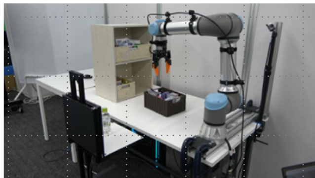
図 4-1 画像指示インターフェースを用いた遠隔操作による複数 CA 協調配膳タスク
