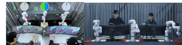
(1) 2人が協調して3体のロボットを操作可能な2×3 CAシステム
