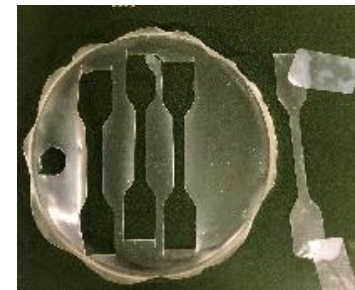
組換え微生物（大腸菌）で合成したモノマー配列が制御されたポリエステルのフィルム
