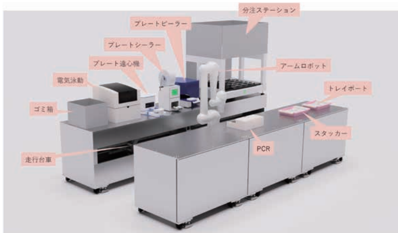
機器配置の一例。プロトコルに合わせて任意の機材を自在に配置でき、LabCodeによるスケジュールングで自動実験が可能となる。
