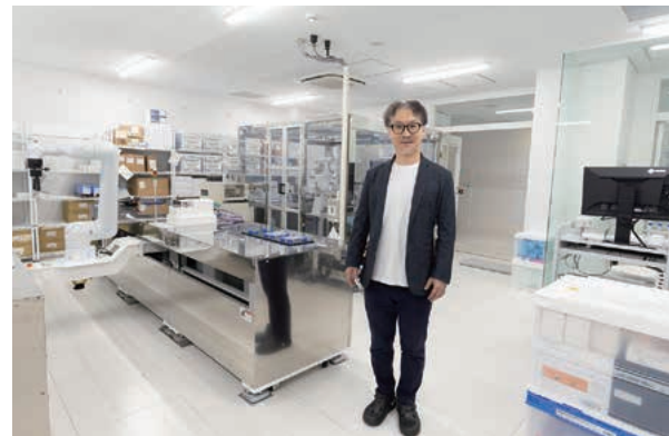
次世代型実験ロボットシステム。6軸単腕アームを採用したことにより、省スペースでティーチングコストも低減した。
