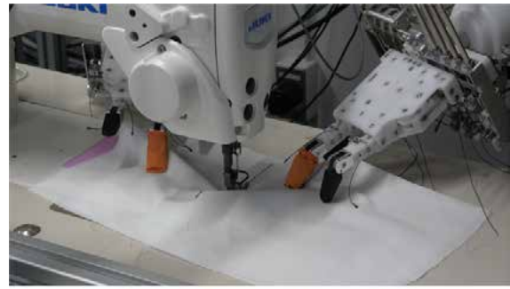
開発したスマートロボットによる自動縫製の様子 機械学習で未知の布に対しても自動縫製が可能
