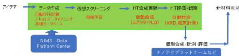
図 1 : Materials Foundry における材料開発のワークフロー図
