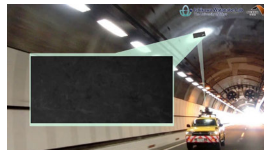
時速100kmでの高速道路点検
