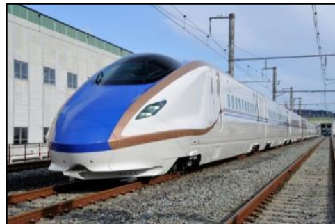
E7系(2015) VVVFインバータ制御・回生ブレーキ
