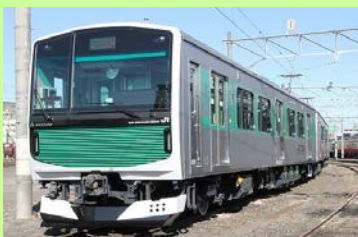
EV-E301系(2014) 蓄電池電車(ACCUM)
