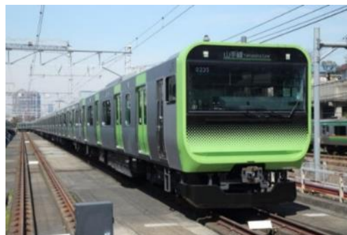
E235系(2015) VVVFインバータ制御・回生ブレーキ
