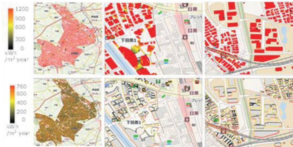
図8 目黒区、屋根面（上）および壁面（下）の年間日射量を計算した結果を記載した地図（ArcGIS Proにて作製）
