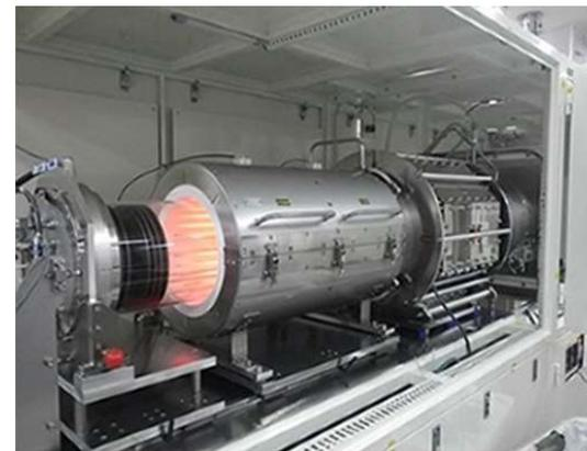
図 HVPE装置写真（沖電気HPから）
