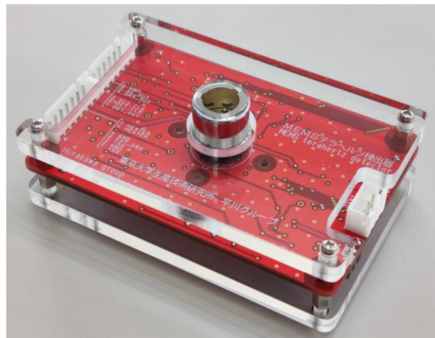
MEMS 高速テラヘルツ検出器の概観 (MEMS 検出素子と駆動読み出し回路)
