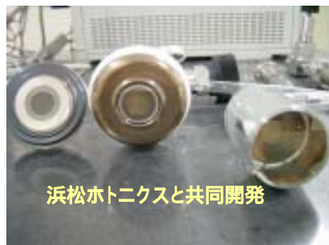
図 10 . 山形大学が浜松ホトニクスと共同で開発を続ける光電面付 CP ガス検出器。
