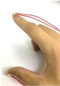
図 7. 指爪上に振動子を取り付けた様子
