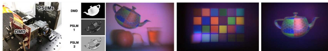
図:色再現性とコントラストが大幅に改善した光減算ディスプレイ(ティーポットとマスクパターンがヴァーチャルな映像)
