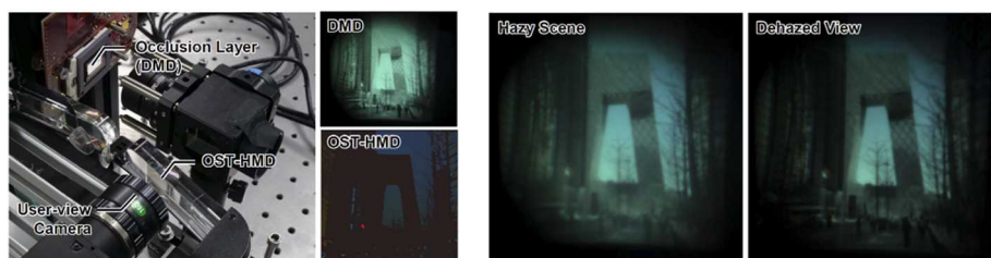
図： Dehaze Glasses。光学シースルーな映像加減算により視界のコントラストを先鋭化する
