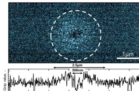
図6 10  $\mu\text{s}$  近接場光加熱による熱的脱離
