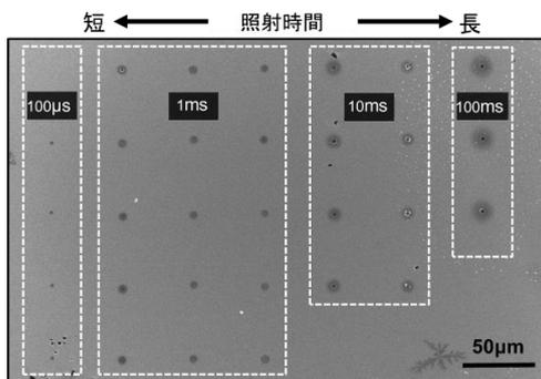
図5 近接場フォトサーマル効果による熱的脱離
