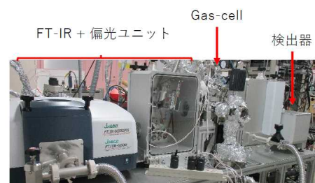
図 1. オペランド赤外分光装置写真
