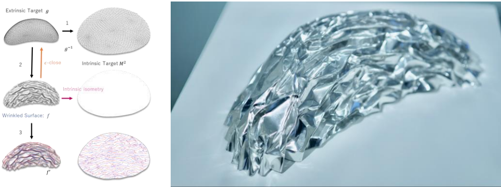
図: (左) 内在的、外在的ターゲットから、折り目パターンを生成する (右) 生成されたパターンを用いた曲線折紙 ([4])
