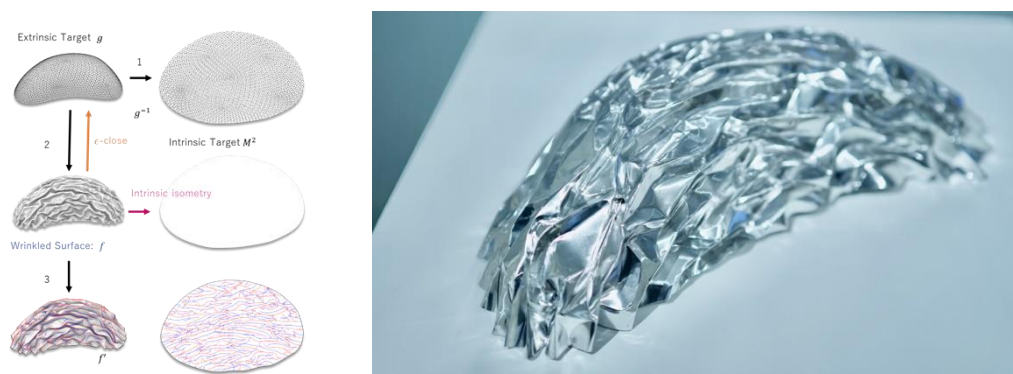
図 9 (左) 内在的、外在的ターゲットから、折り目パターンを生成する (右) 生成されたパターンを用いた曲線折紙 (館知宏氏の研究終了報告書より)
