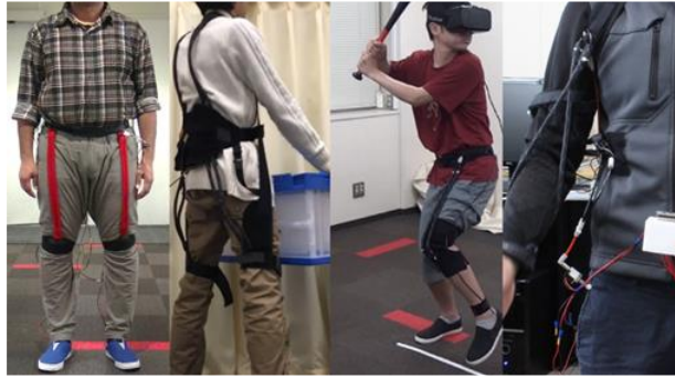
空気圧ゴム人工筋を利用した柔軟軽量なソフトエグゾスケルトンスーツと運動支援、スポーツ拡張、力覚フィードバックスーツへの応用
