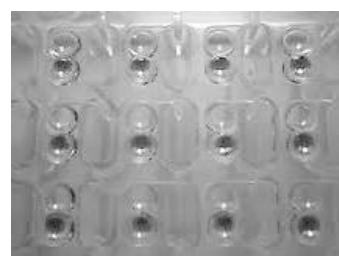
図2 作製した結晶化プレート。シットティングドロップ結晶化容器に金ナノ構造を構築してある。このウェルにドロップされた溶液から結晶が出現しやすくなる。
