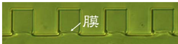
図4:マイクロチャンバの出口付近に脂質膜を形成した様子。接触法を応用し、水、有機溶媒、水を交互に流すことによって、安定して大量に膜を形成できることがわかった。
