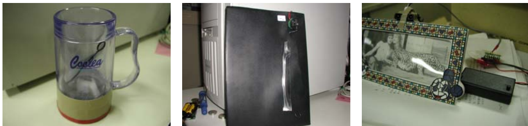
図 9 無線センサノードを付与した物体。左から、加速度センサと光センサが付いたコップ。加速度センサと曲げセンサが付いた本。人体センサの付いた写真立て。
