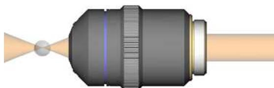
図: 急峻に収束した光を用いて微粒子を捕捉・固定・操作する光トラップ技術の模式図。
