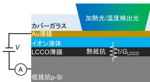
Fig. 1-2. 熱伝導の電氣的制御とその場観察系
