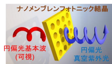
図1: ナノメンブレンフォトニック結晶を用いた円偏光波長変換の模式図
