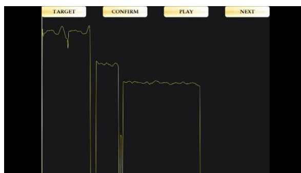
図 1: 実装した歌唱デザインインタフェースのプロトタイプ。横軸は時間、縦軸は歌声の高さを表す。再生中に画面上にタッチし上下させることで、実時間での高さ制御を実現している。
