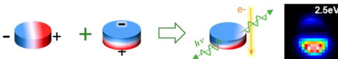
図：直径 130nm の銀ナノディスクにおける面内・面外双極子間の干渉(左)による非対称な電場分布(右) [ACS Photonics, 5 (12), 4986-4992, 2018.]
