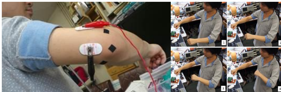
図 5 腱電気刺激による運動錯覚の生成。(左) 刺激部位 (右) 右腕刺激時の姿勢錯誤を左腕で示したもの。
