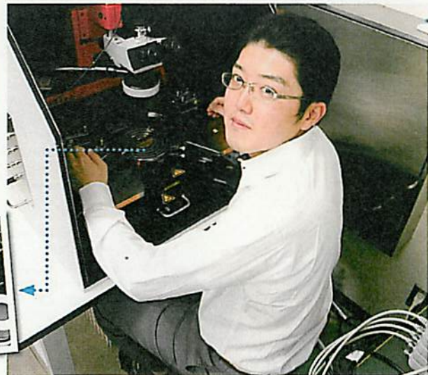
完成したトランジスタのスイッチ特性を測定する装置。さまざまな測定機器を用いて3万個もの試作品の実証作業を行い、「夢のトランジスタ」は誕生した。
