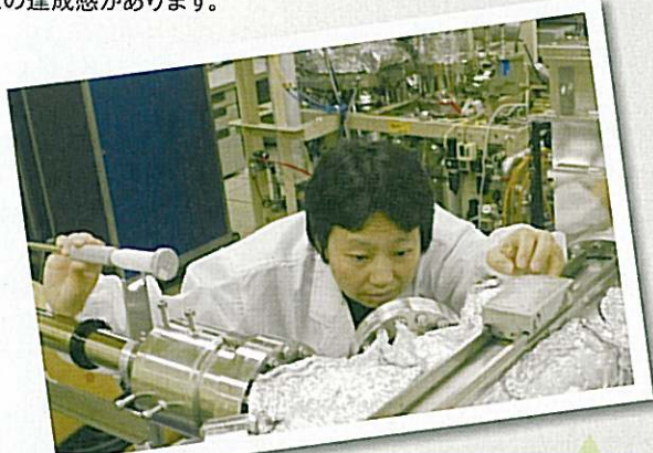
超高真空スパッタ装置でスピントロニクス素子を作製中。
