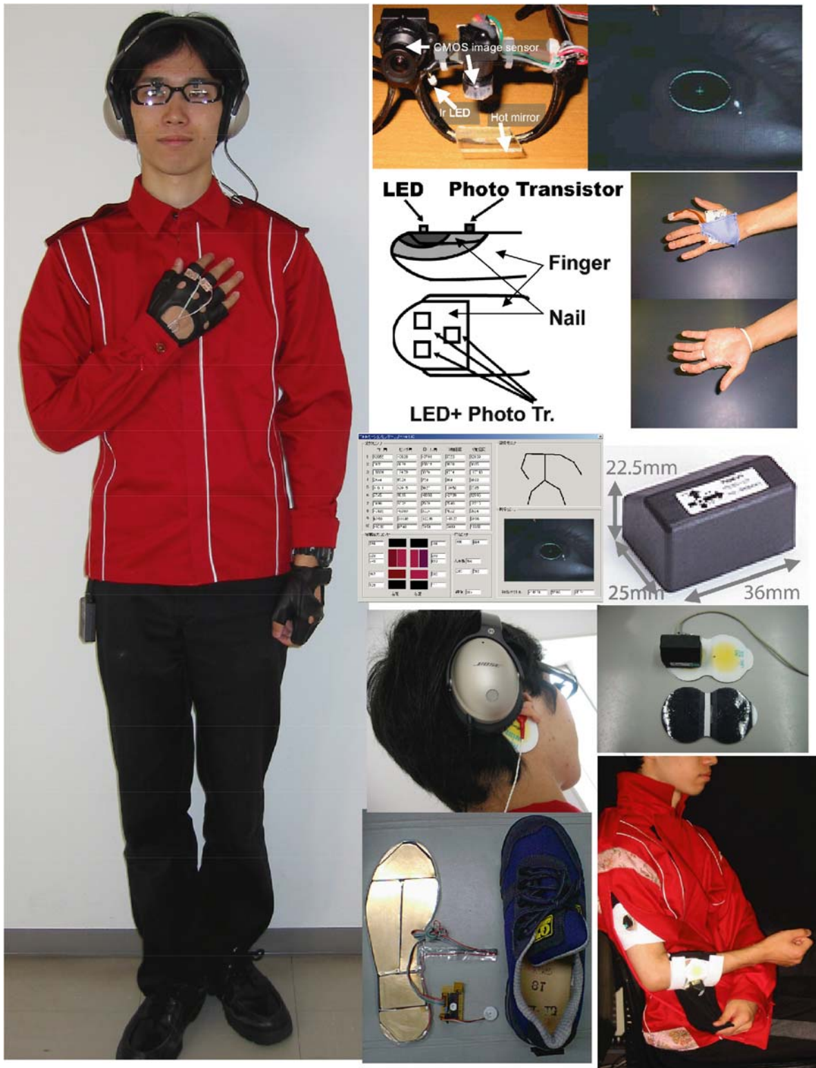
第2図 PH 試作3号機と各部構成: 左上方より順に全身像, 眼球運動検出器, 眼球位置計測結果の検証写真, 爪センサの実装概念図, 爪センサ実装状態写真, PH稼働状態モニタリング画面, 身体運動計測用3軸姿勢センサ外形写真, 前庭感覚刺激電極装着写真, 身体各部電気刺激電極と電極上に固定された姿勢センサ, 重心位置計測用荷重センサを配した靴底センサ部写真, 装着者が片手で付け外し出来るように工夫された服の構造と電極・姿勢センサの装着過程.
