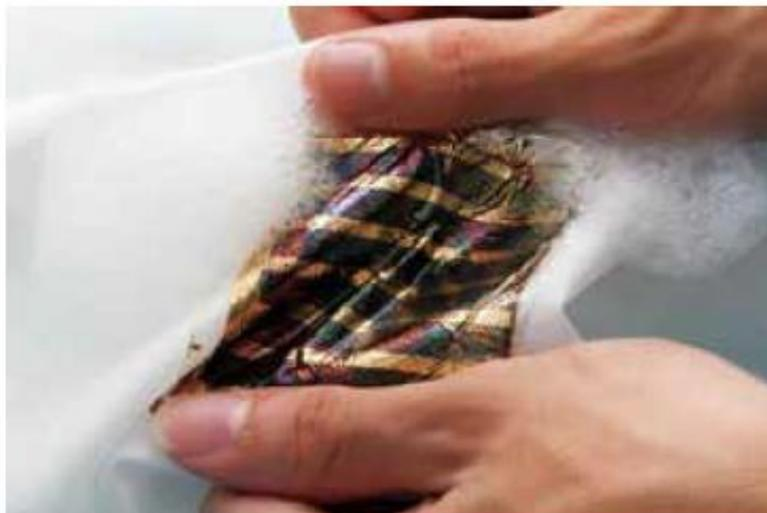
図 A2-12 衣服上に貼り付けた超薄型有機太陽電池の洗濯
