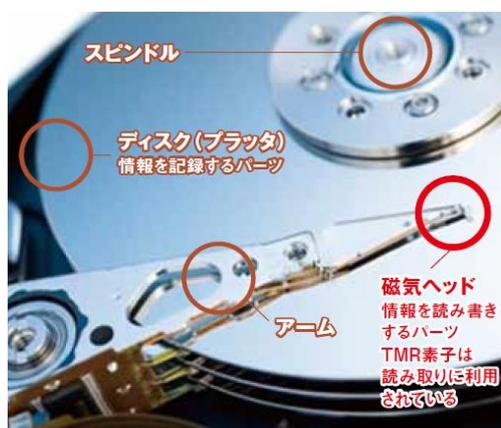
図 A2-31 ハードディスクの内部構造
