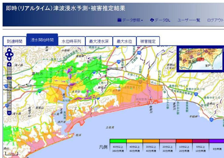
図 A2-19 リアルタイム津波被害予測システムの出力結果(例：浸水開始時間)
